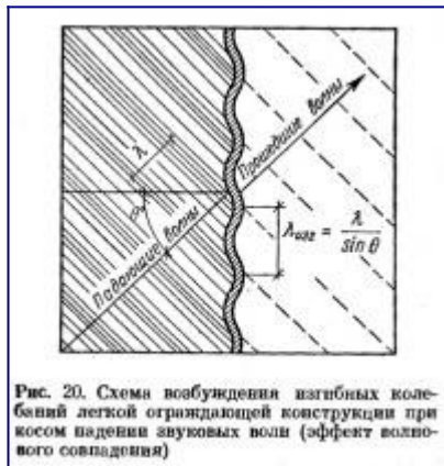
Рис. 20 Схема возбуждения изгибных колебаний легкой ограждающей конструкции
